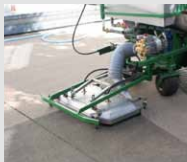
↙ Ook voor de reiniging van drainagelagen is deze machine geschikt.
