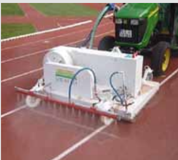
↙ De voorreiniging gebeurt door middel van een speciale sproeibuis.
