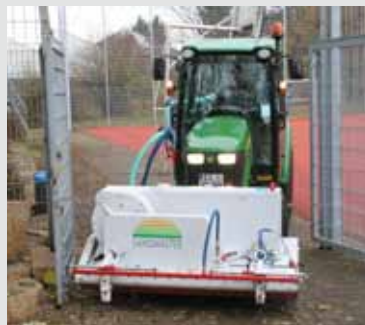
↙ De machine gaat probleemloos door toegangen van minstens 1,80 m breed en 2,40 m hoog.
